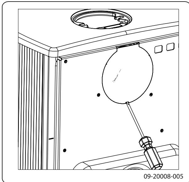
3. Desmonte la cubierta de la pared posterior.
