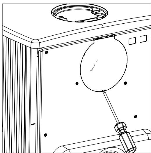
3. Démontez le couvercle de fermeture de la paroi arrière.
