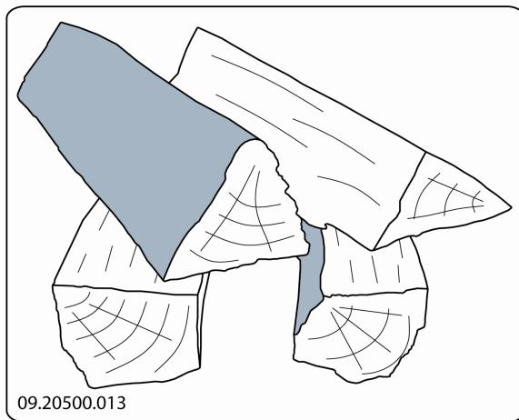
Apilando los leños de manera suelta, la madera se quema mucho más rápido, ya que el oxígeno puede llegar a todas las partes de la madera. Utilice un apilamiento suelto si quiere conseguir un fuego rápidamente.
