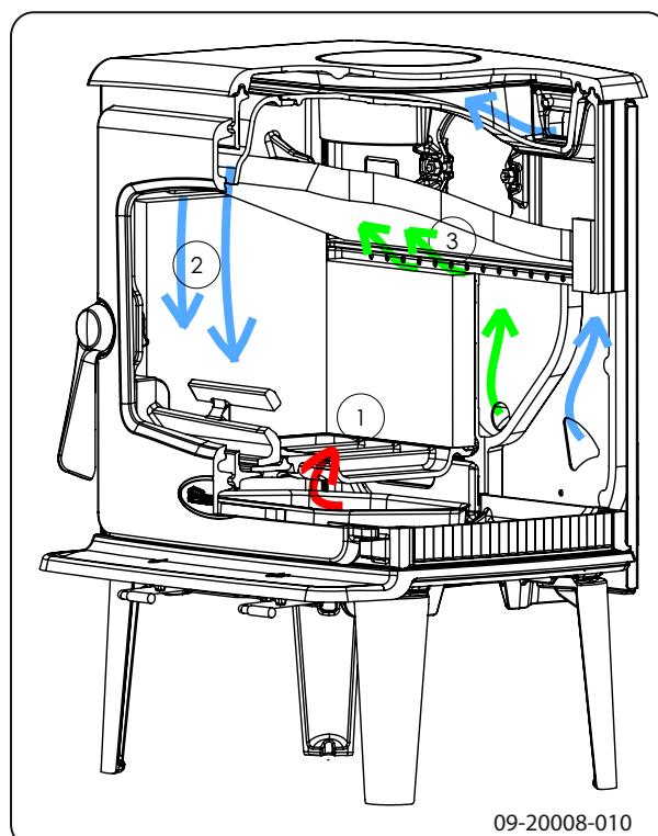
Le registre d'air primaire permet de régler l'air sous la grille (1).
