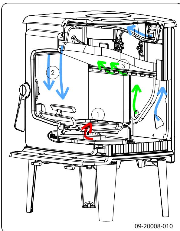
Die primäre Luftklappe regelt die Luft unter dem Rost (1).
