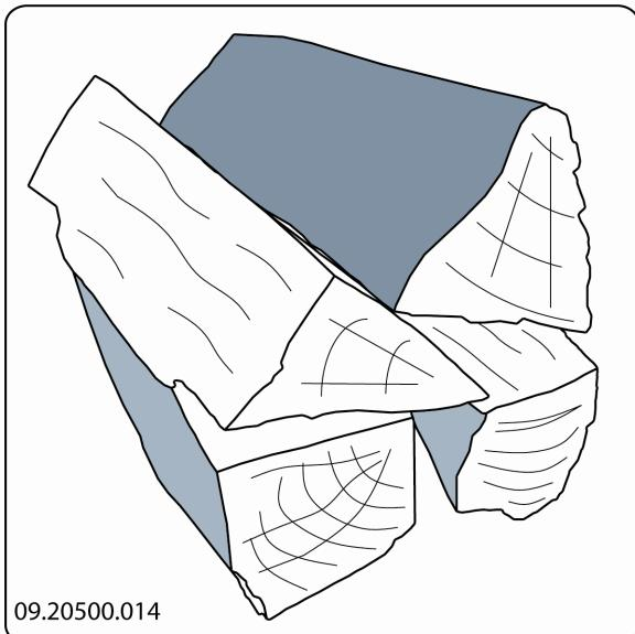
Apilando los leños de manera compacta, la madera se quema más lentamente, ya que el oxígeno no puede llegar a todas las áreas de la madera. Utilice un apilamiento compacto si desea mantener el fuego encendido durante mucho tiempo.
